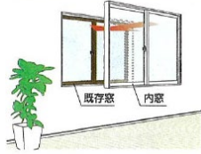
既存窓の内側に新たな窓を設置
